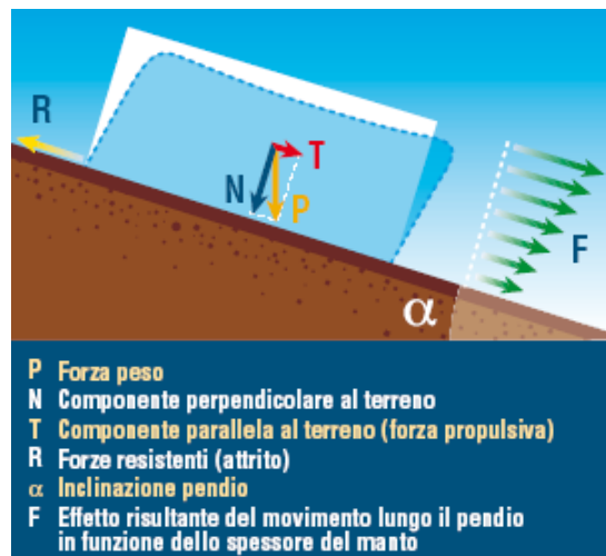
Figura 28 – Parametri che concorrono alla formazione di una valanga
