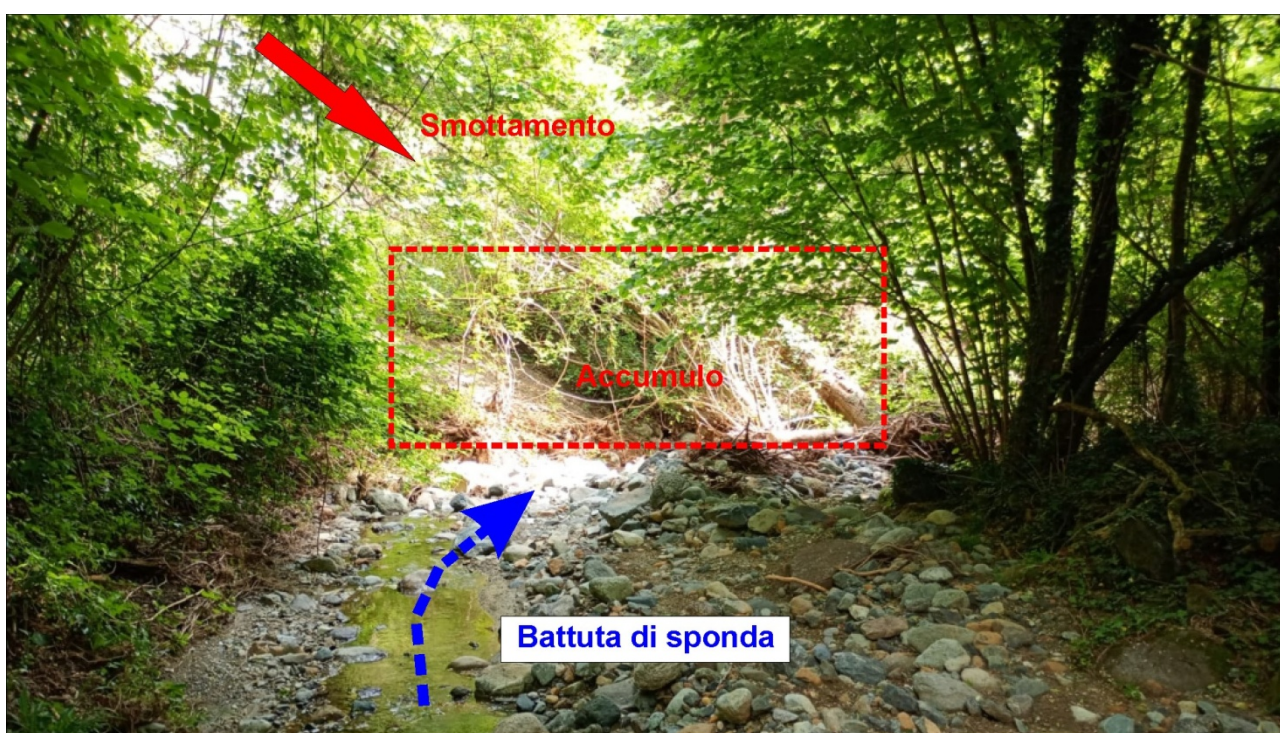
Fig.3: vista sulla zona basale dello smottamento N, con indicazione della battuta di sponda del torrente.
